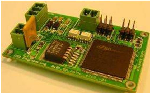
DRS-200-AS System - für Drehstrom Synchron- oder Asynchronläufer als 1-Achsen Anlage mit integriertem Motorenverstärker und schnellen Abbremsverhalten durch spezielle elektronische Kommutierungen.
